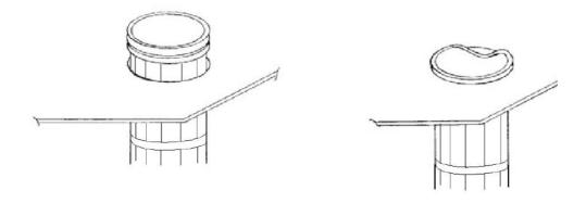
A manga não deve girar se forçada, quando instalada no orifício da placa espelho.
